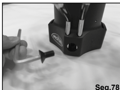
Dévisser les vis de bras arceaux. Unscrew the drum cage screws.
