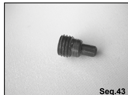
Monter les vis en haut de l'avale ridoir. Fit the screws to the top of the turnbuckle cylinder.
