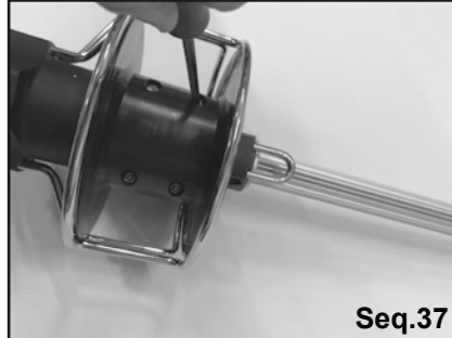
Démonter le tambour. Remove the drum.
