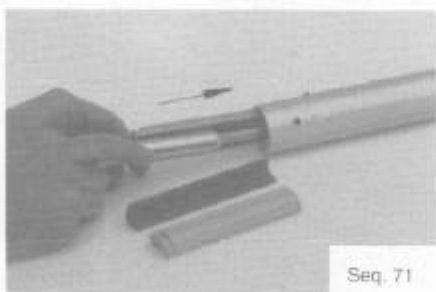
Glissez dans la gaine inférieure. Slide into the lower extrusion.
