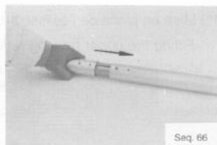
Assemblez avec la gaine voisine. Fit with the next extrusion.
