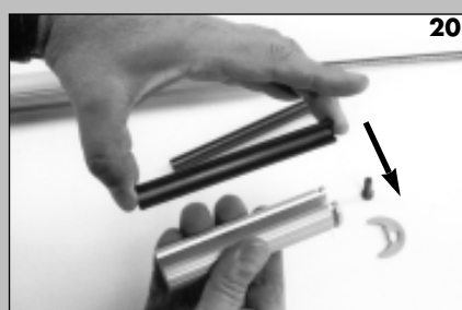
Prenez l'éclisse supérieure Take the upper bearing holder
