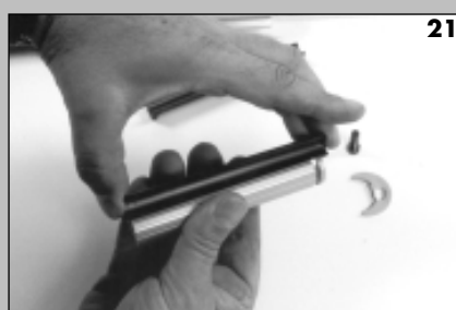
Montez 1/2 palier dans l'éclisse Fit one 1/2 bearing into the bearing holder
