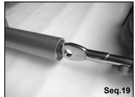
Enfiler le câble dans la gaine coupée. Slide the top extrusion up the forestay.
