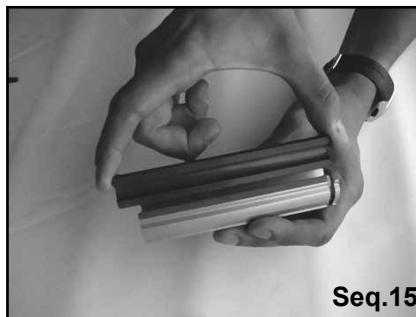
Monter le 1/2 palier dans l'éclisse. Fit one 1/2 bearing into the bearing holder.
