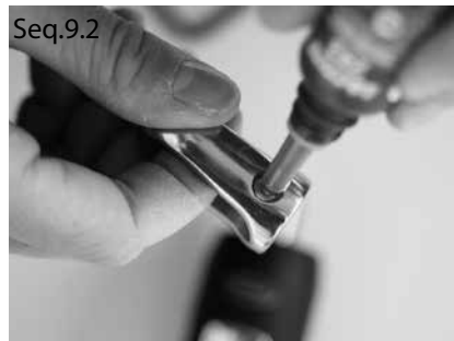
Seq.9.2 Appliquer la colle sur le taraudage de l'oeil Apply the glue on the thread of the eye
