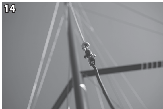
14 Hisser l'émerillon & le câble anti-torsion en tête de mât à l'aide de la drisse de spi. Hoist the swivel and the anti-torque cable up to the mast head with the spinnaker halyard.
