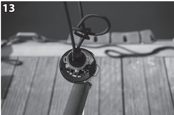
13 Installer la poulie crantée sur le point de fixation (bout-dehors...) Install the spool on the fastening point (bowsprit...).
