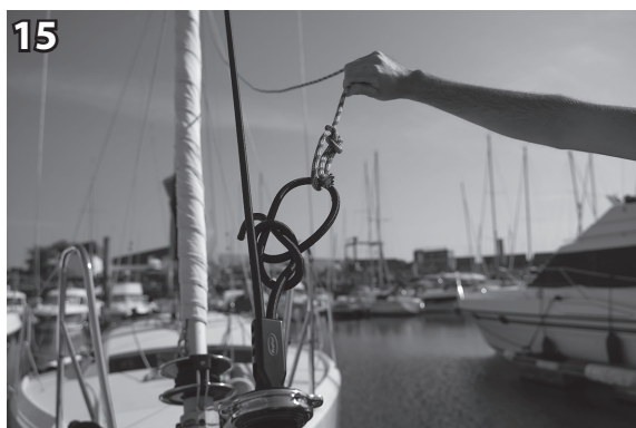
15 Frapper une 2ème drisse au noeud de chaise du câble anti-torsion. Attach a 2nd halyard to the anti-torque cable knot.
