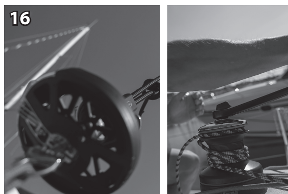
16 Hisser la 2ème drisse afin de mettre le câble sous tension. Hoist the 2nd halyard in order to tension the cable.
