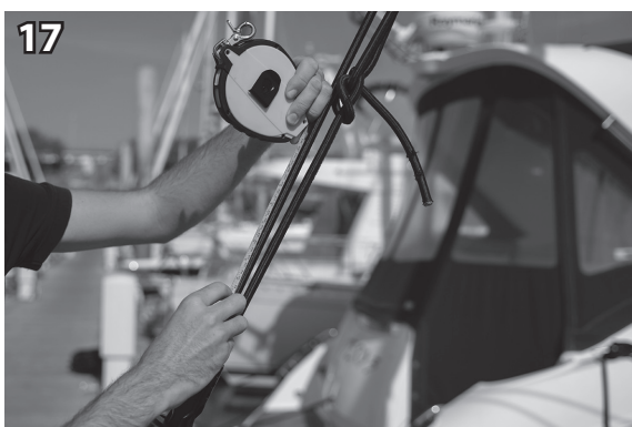
17 Faire une marque à l'aide d'un scotch sur le brin montant en tête de mât à 10 cm au-dessus de la cosse inférieure. By using the tape, make a mark on the anti-torque cable line tensioned - around 10 cm above the lower thimble.
